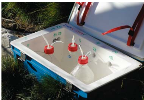
Obr. 102 Box s podtlakovými fľašami na zber vzoriek pôdnej vody a detail sukčného keramického lyzimetra
