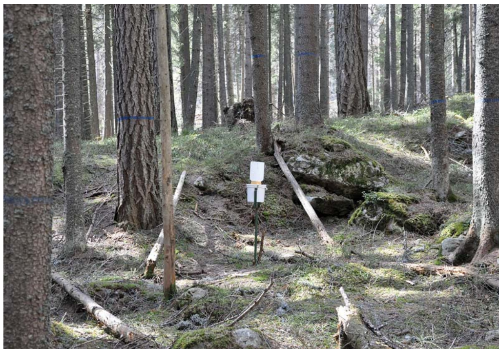
Obr. 20 Kolektor na odber vzoriek podkorunových zrážok pre chemické rozborý
