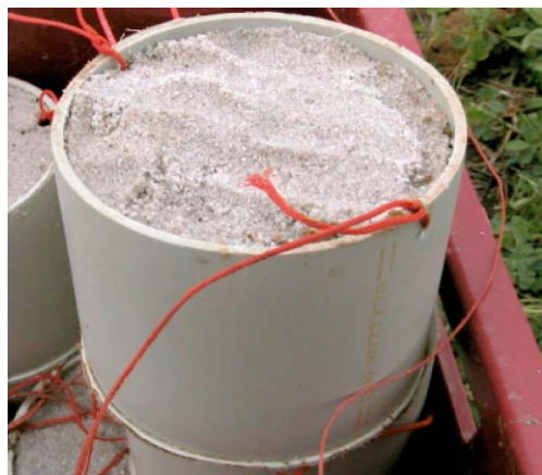
Obr. 99 Umiestnenie SAI v 60 cm a detail na absorbčný valec s kremíkovým pieskom (zdroj BISCHOFF et al. 2008)
