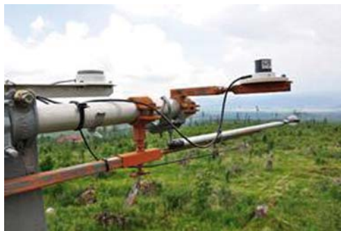
Obr. 67 Snímače bilancie žiarenia a globálneho žiarenia na meteorologickom stožiarí na ploche EXT
